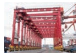
トランスファークレーン
