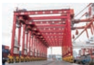
トランスファークレーン
